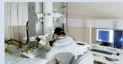
顕微鏡室【走査型電子顕微鏡】 試料表面を電子銃からの収束電子線で走査し、発生する 2次電子から試料表面の凹凸を画像化します。微細な 表面構造の解析が可能です。
