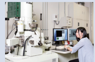
大学院棟実験室 走査型電子顕微鏡と最先端のナノスーツ法を 併用することで、生きたまま生物の微細な表面 構造の解析を、高倍率で行うことができます。
