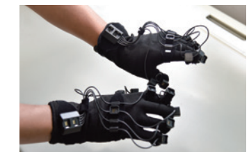
センサを装着して動きを測定し、デジタル化するモーションキャプチャシステムも活用
